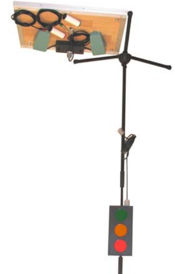
Rysunek 5 – Sygnalizator bodźców świetlnych i zespół odbioru bodźców
