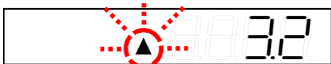
Rysunek 11 - Wyświetlacz podczas odmierzania czasu reakcji - odpowiedni symbol na wyświetlaczu podświetlony jest światłem pulsującym, z prawej odmierzany jest czas
