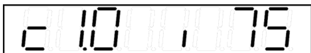
Rysunek 4 - Wygląd wyświetlacza po osiągnięciu przez aparat gotowości do pracy - prezentacja domyślnego czasu badania i częstotliwości zmiany bodźców
