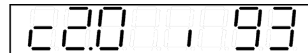
Rysunek 6 - Ustawianie częstotliwości zmian bodźców - 93 bodźce na minutę - wartość wyświetlana z prawej strony wyświetlacza
